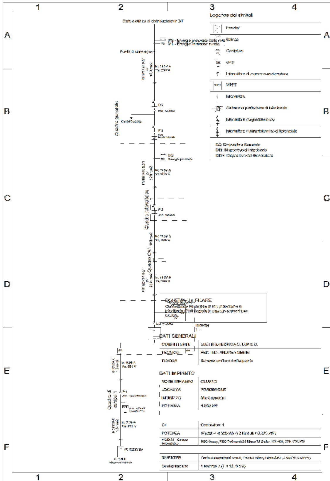
Fig. 8: Schema elettrico unifilare dell'impianto
